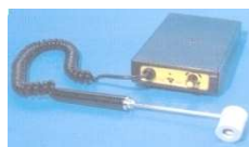
Sensore particolarmente sensibile al metano emette un impulso sonoro. Alimentazione con 4 pile.
