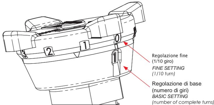
Dato i valori di portata e la perdita di carico richiesta per il bilanciamento, ricavata dal diagramma di regolazione la corrispondente posizione di apertura, per presettare la valvola procedere come segue:
